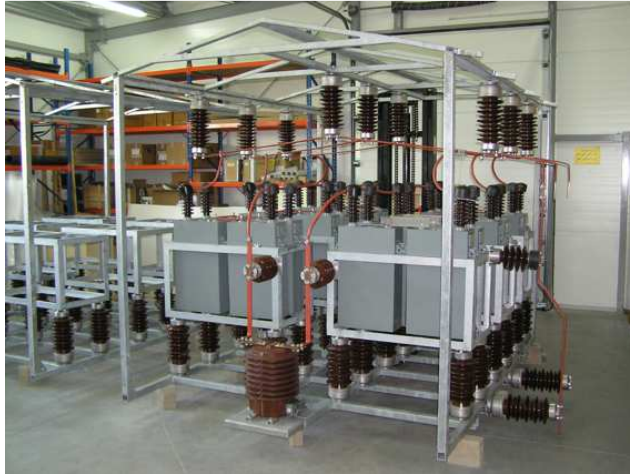
Fot. 13. Bateria 5MVar/33kV dla specjalnych wymagań środowiskowych: klimat tropikalny, z daszkiem osłony od słońca i osłonami przed ptakami, montowana na słupach. Realizacja „ELMA energia” przed wysyłką do klienta.
