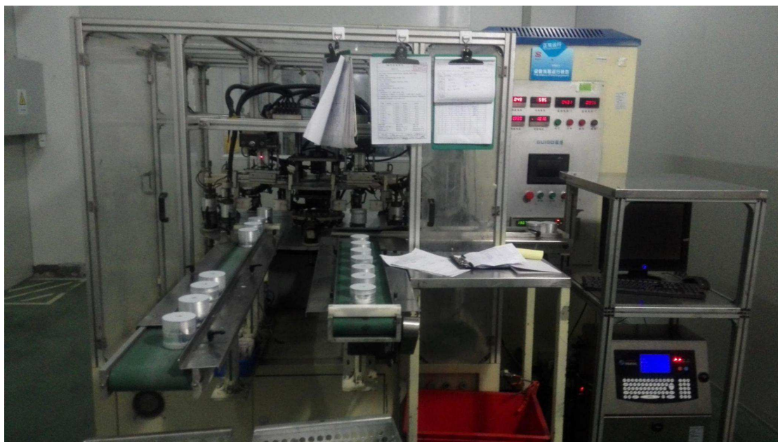
Rys. 2. Badanie pojemności zwijek przed montażem w obudowie kondensatora
